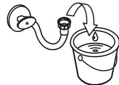
**b** Ajuste el paso del agua de la manguera con el regulador según la cantidad de agua que requiera el inodoro para el sello hidráulico.
