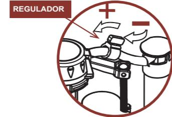
**c** Para regular la descarga de agua utilice las ventanas laterales.
