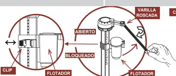
**e1** Para limpiar el cabezal de la válvula, siga las instrucciones del paso "d", luego gire en sentido antihorario y retire el cabezal de la válvula.
