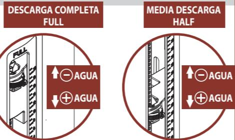
**d** Para regular el nivel de agua indicado en el estanque, gire a 90° y desconecte la varilla roscada del flotador, luego libere el clip y deslice el flotador.
