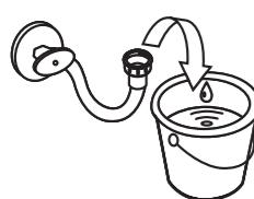
**b** Ajuste el paso del agua de la manguera con el regulador según la cantidad de agua que requiera el inodoro para el sello hidráulico.
