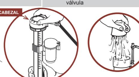
**e2** Coloque un recipiente sobre la base del cabezal de la válvula sin tapar para evitar salpicaduras, abra y cierre el suministro de agua varias veces. Deje el suministro de agua cerrado. Vuelva a instalar el cabezal de la válvula.
