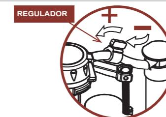
**c** Para regular la descarga de agua utilice las ventanas laterales.
