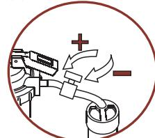
**c** Para regular el nivel de agua utilice un destornillador.
