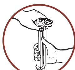
**f** Pase la cadena a través de los orificios de la manija para que el flaper abra y cierre correctamente.
