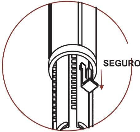
**c** Para regular el nivel de agua utilice un destornillador.
