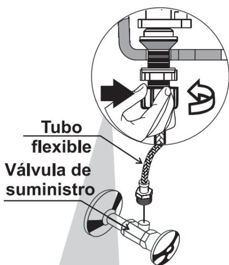
**7** Conecte el tubo flexible de suministro de agua a la válvula de ingreso del inodoro. Abra la válvula de suministro y llene según la marca en el estanque (water level) regulando el flotador (ver recomendaciones de Instalación Paso "c").
