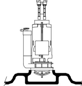
**8** RESTITUCIÓN DE SELLO HIDRÁULICO: Conecte la manguera en el regulador.
