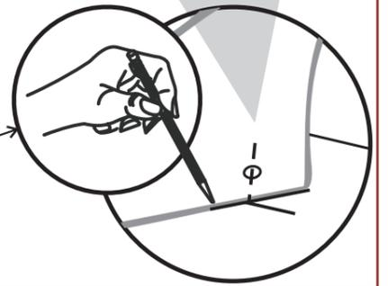
**4** Instale las placas plásticas en "L" considerando el espesor de pared del inodoro.
