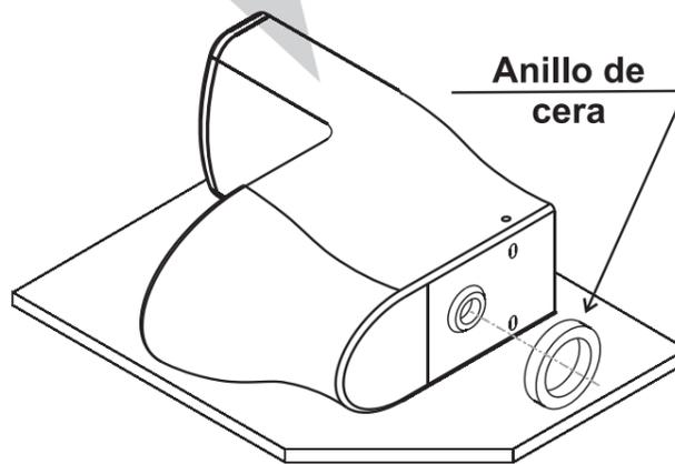
**6** Pase el autorroscante por el orificio del inodoro hasta que sobrepase la placa plástica en "L". Ajuste y coloque el capuchón.
